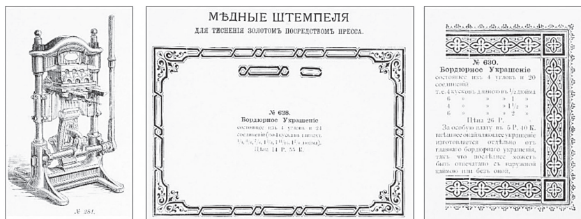
Рис. 2. Пресс для тиснения на переплете и образцы рамок-клише, предлагаемых поставщиками оборудования (из «Прейскуранта для переплетных заведений Франца Марка и Ко, Санкт-Петербург», 1892 г.)
